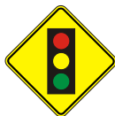
Proximidad de Semáforo
